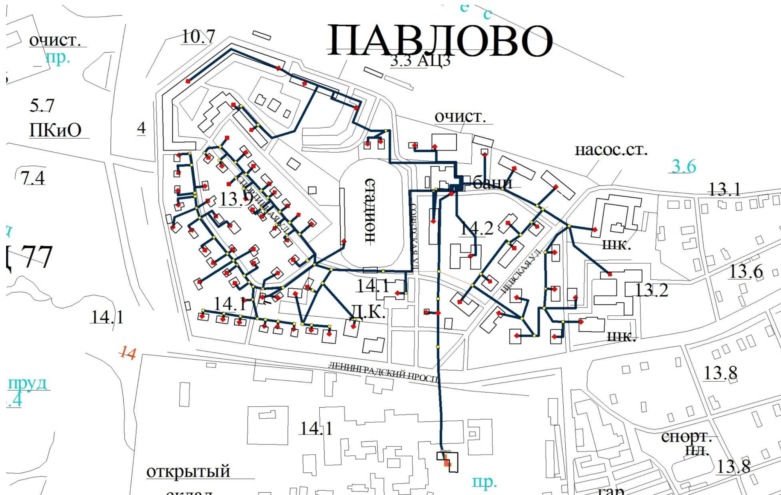
Рисунок 3.4.2. Схема существующих тепловых сетей поселка Павлово.
